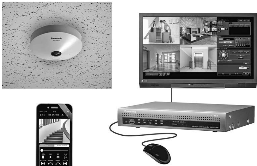
内装になじむデザインの全方位カメラ (左上) スマートフォンアプリ画面 (左下) WJ-NX100シリーズと操作画面 (右)
