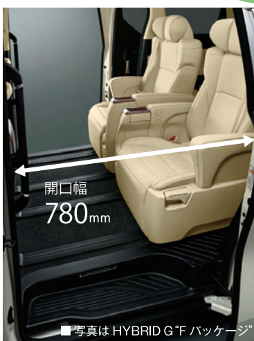
セカンドシート・サードシートへのアクセス向上 ホイールベースを延長することにより、スライドドア開口幅を780mmへと拡大。セカンドシート、サードシートへのスムーズなアクセスを可能にした。
