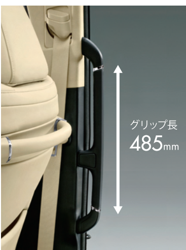
アシストグリップの大型化 485mmへと大型化したロングアシストグリップを採用。低い位置に設定したことにより、幅広い年齢層の方の乗り降りをサポートする。
