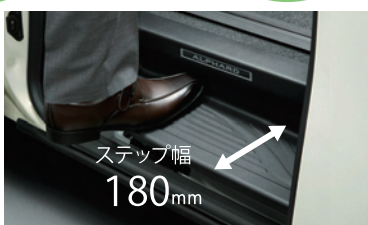
低床化による乗降性の向上 フロアの低床化によりステップも350mmと低く、幅も180mmへと拡大。さまざまな体格、服装の方が乗り降りしやすいようにした。
